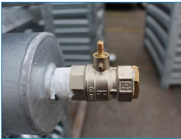
Bovenste batterijaansluiting met drukaflaatklep op condensors.
