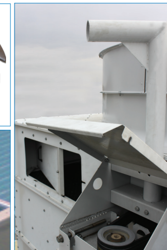
Скользкая внутрь дверца люка. Мотор с наружными регуляторами и направляющими для демонтажа*
