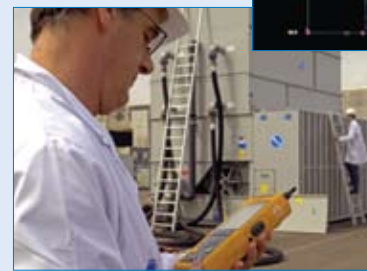
Comprobación de temperatura en una torre de refrigeración
