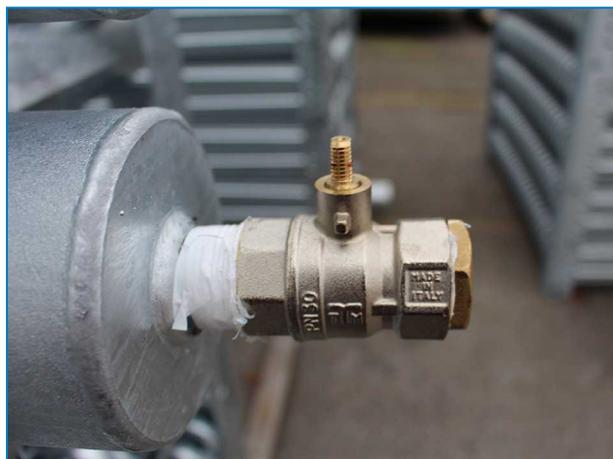
*Соединение верхнего теплообменника с клапаном, стравливающим давление, на конденсаторах.*
