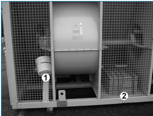
Ort des Montagmaterials und der Pumpe
