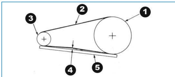
*Réglage de la courroie de ventilateur*
