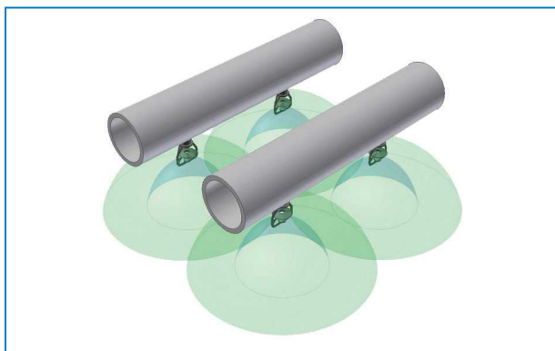
Distribution par pulvérisation de condenseurs
