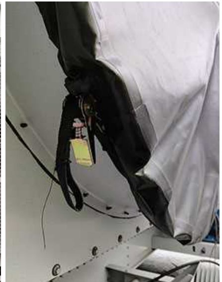
Serrer la sangle pour fixer le couvercle
