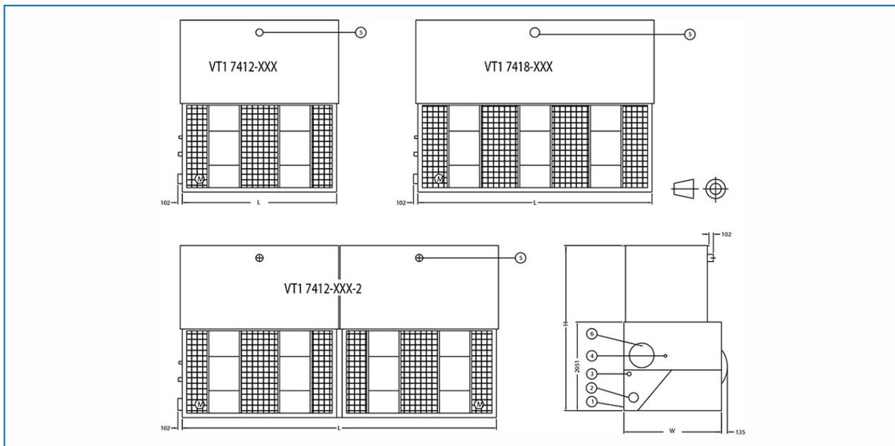
1. Vidange DN 50 ; 2. Sortie d'eau ; 3. Trop-plein DN 50 ; 4. Appoint d'eau DN 25 ; 5. Entrée d'eau ; 6. Porte d'accès
