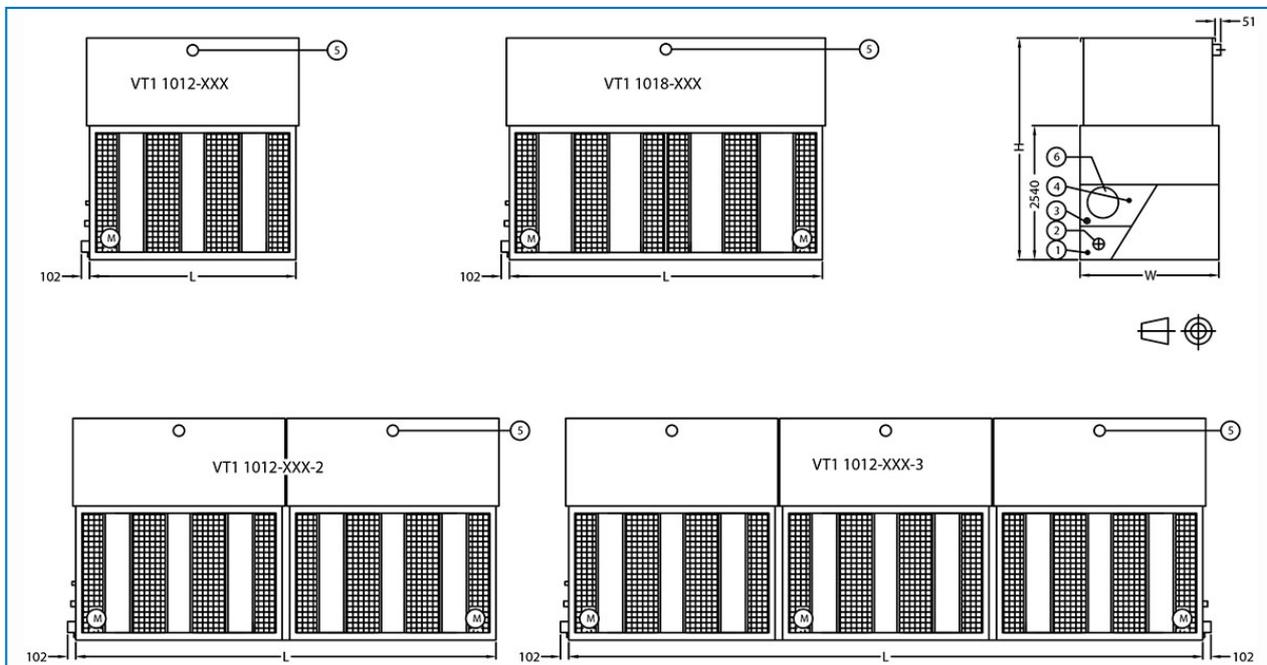
1. Vidange DN 50 ; 2. Sortie d'eau ; 3. Trop-plein DN 50 ; 4. Appoint d'eau DN 25 ; 5. Entrée d'eau ; 6. Porte d'accès
