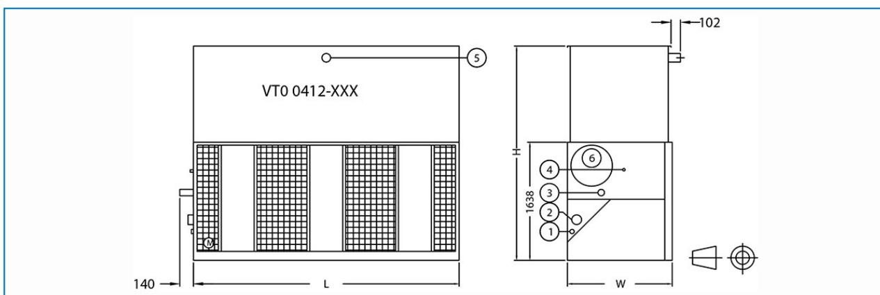
1. Vidange DN 50 ; 2. Sortie d'eau ; 3. Trop-plein DN 50 ; 4. Appoint d'eau DN 25 ; 5. Entrée d'eau ; 6. Porte d'accès
