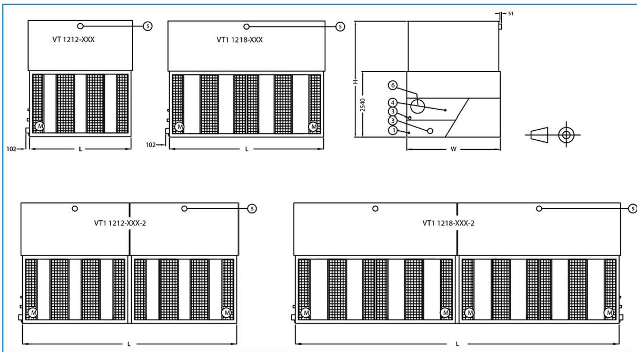
1. Vidange DN 50 ; 2. Sortie d'eau ; 3. Trop-plein DN 50 ; 4. Appoint d'eau DN 25 ; 5. Entrée d'eau ; 6. Porte d'accès
